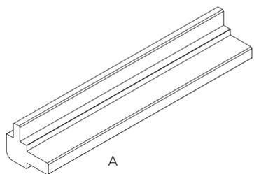
A: Strumento di montaggio dell'imbuto SG 6827
