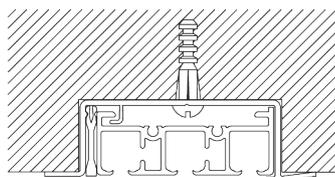
Uno spessore per profilo a incasso SG 10157 per ogni punto di fissaggio.
